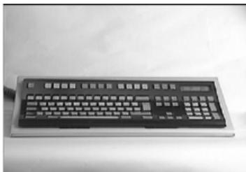
L'accessibilità può essere realizzata con modalità "creative" di usare tastiera e mouse (es. battendo con un **bastoncino** impugnato con la bocca o montato su un caschetto posto sul capo, e mascherando la tastiera con uno **scudo** forato in corrispondenza dei tasti, come illustrato nelle figure sottostanti); oppure si può ricorrere ad ausili informatici di tipo hardware, software o hard/software.
